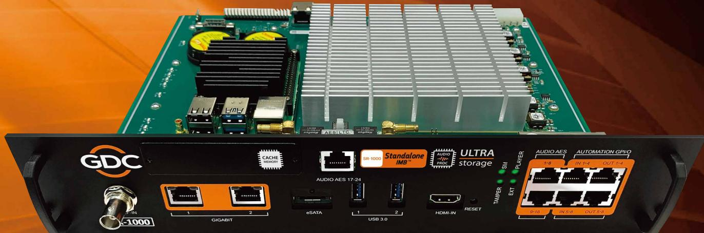
GDCテクノロジーは、デジタルシネマの登場以来、常に技術開発の最前線に立ち続けています。業界初のユニークな新商品発表から、技術サービスの提供に至るまで、GDCは統合メディアブロック (IMB) のリーダーとして業界をリードしてきました。SR-1000は、同社の第6世代デジタルシネマメディアサーバーで、メンテナンスがほぼゼロで、総所有コストを最小限に抑えられるように設計されています。SR-1000は、最大500MbpsのビットレートでSMPTEおよびInteropデジタルシネマパッケージ (DCP) の再生をサポート<sup>1</sup>、DTS:X™イマーシブオーディオソリューションは、SMPTE ST 2098-2 immersive audio bitstream (IAB) 規格をサポートしています。
