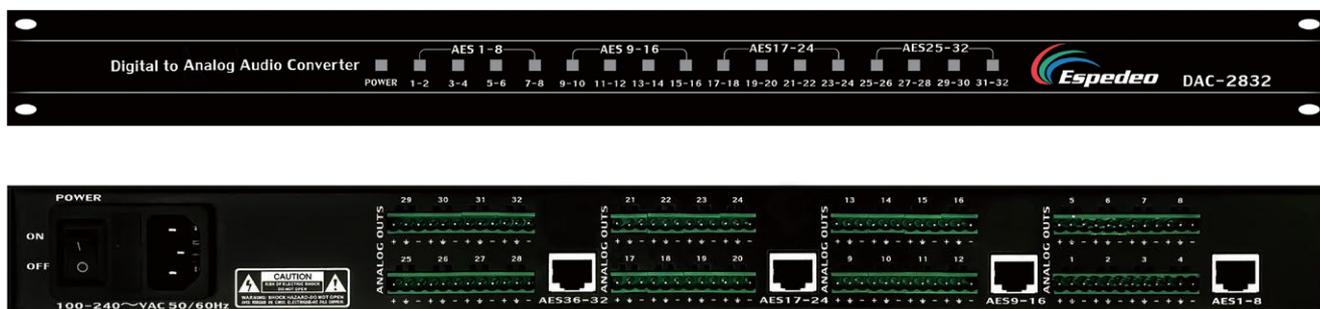
DACシリーズは、SR-1000インテグレートドメディアブロック™と接続するために設計された、5種類のデジタル-アナログ音声コンバーター(DAC)モデル[8 / 12 / 16 / 24 / 32チャンネル]を提供します。各モデルは、RJ-45ソケットを介して指定された数のAES3デジタル音声入力に対応し、出力はPhoenixコネクタから利用できます。DACシリーズの前面パネルのLEDインジケータは、各AES3ペアの信号状態を表示し、エンターテインメント用途向けに音声インターフェースソリューションを提供します。
