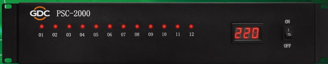
PSC系列是一款专为影院还音系统设计的可按顺序进行供电的控制器，为影厅音频解码器和功率放大器等音响设备有序地供电，避免多个音响设备同时开机产生的巨大启动电流对电路中的设备造成的损坏。一台PSC可以最多连接12台设备进行时序供电，也可以通过RS-232将多台PSC串联进行叠加使用，实现对更多音响设备的时序供电。
