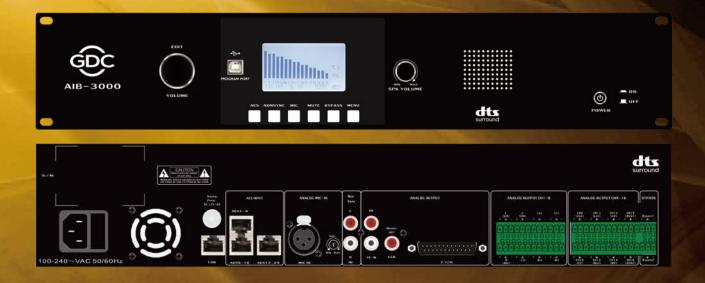
次世代オーディオ・インターフェース・ボックスAIB-3000は、16チャンネルデジタル ・アナログ・コンバーターと、アナログ・アンプ、マイク、メディア・プレーヤーな どの外部オーディオ機器を接続する内蔵ブース・モニターを提供します。AIB-3000は イーサネット経由で入力ソースのリモート切り替えが可能です。
