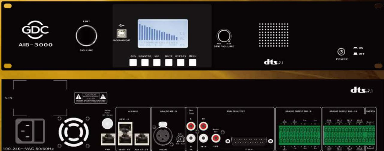
次世代オーディオインターフェースボックス「AIB-3000」は、16チャンネルのデジタル・アナログコンバーターと、アナログアンプ、マイク、メディアプレーヤーなどの外部オーディオ機器と接続するブースモニターを内蔵しています。また、AIB-3000 はEthernet経由で入力ソースのリモート切り替えが可能です。汎用性の高いAIB-3000は、5.1chまたは7.1chのシネマオーディオプロセッサーを内蔵したメディアブロック用に設計されており、オーディオソフトウェアライセンスにより7.1chシネマオーディオプロセッサーとして独立して動作します。
