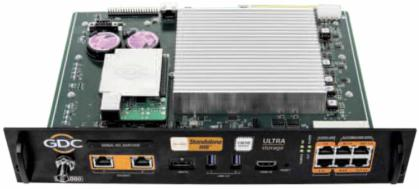
A la izquierda, imagen de una sala con pantalla LED de cines Unilumin, para las cuales GDC tiene un reproductor específico (SRC-7500). A la derecha, tarjeta GDC de su media server SR-1000 IMB.
