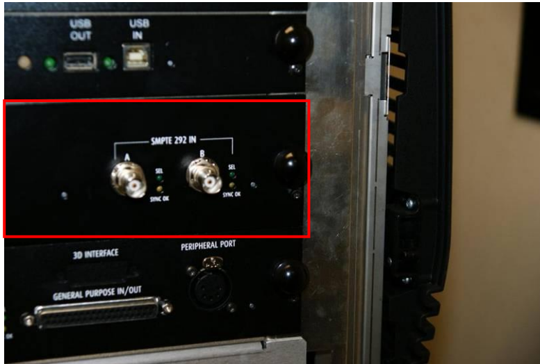
图 3 拆下巴可放映机上的接口板。
