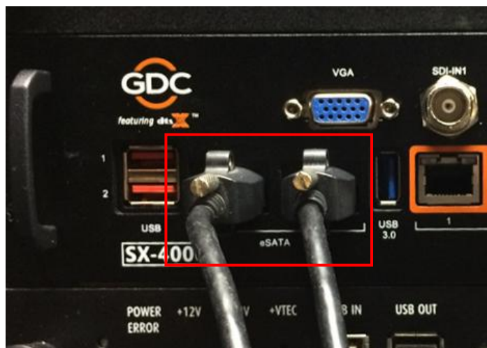
图 14 将 eSATA 线插入 SX-4000 eSATA 端口 2
