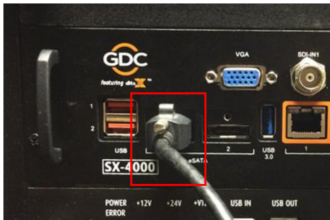
图 13 将 eSATA 线插入 SX-4000 eSATA 端口 1
