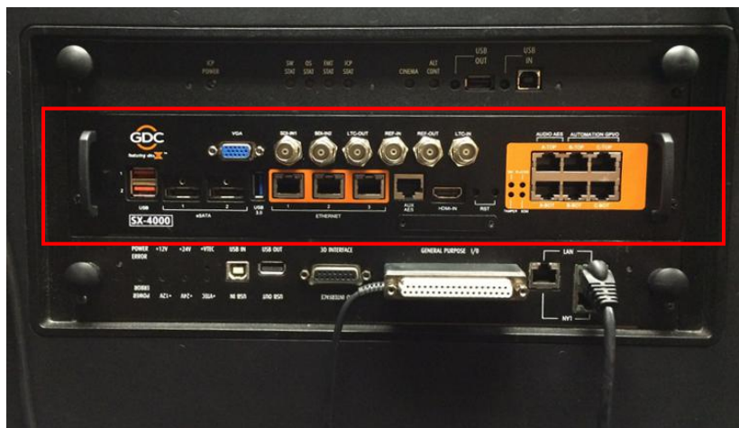
图 7 将 SX-4000 插入放映机
