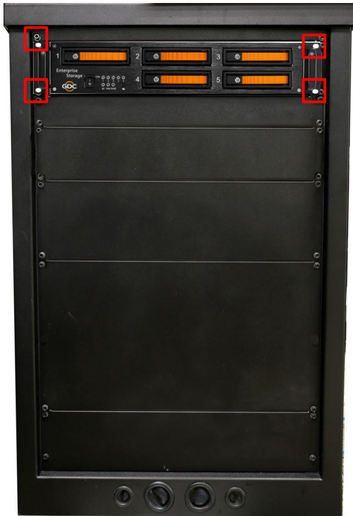
图 10 将企业级存储放在底座上
