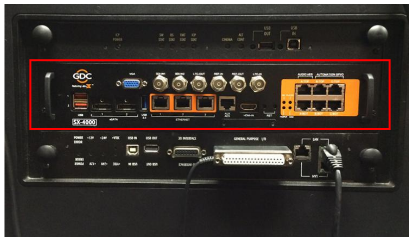
图 4 SX-4000 安装在巴可放映机上的位置
