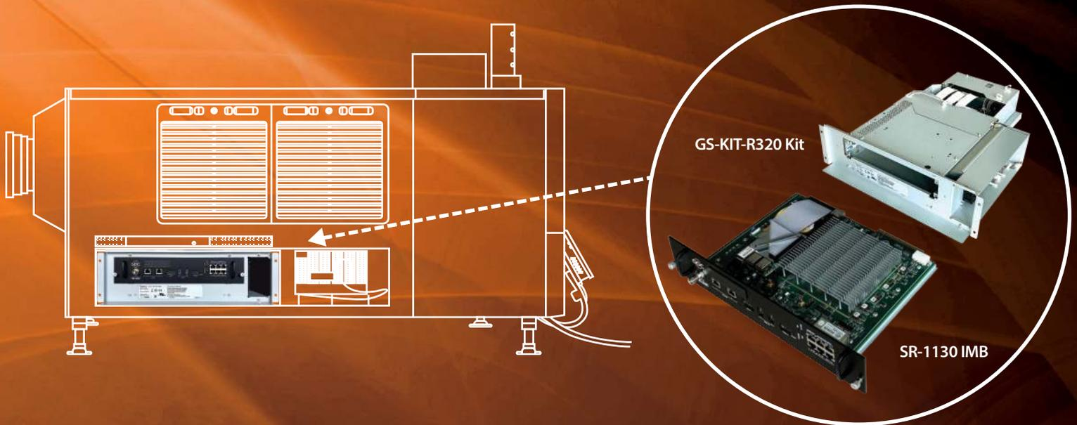
SR-1130 IMB (Integrated Media Block) は、2009年に発売されたソニーの4KデジタルシネマプロジェクターSRX-R320用に開発されたDCI準拠メディアサーバーです。SRX-R320をアップグレードするためのメディアサーバーとして、最も先進的で信頼性の高い製品です。なお、SR-1130 IMBをSRX-R320に取りつけるためには、GS-KIT-R320キットが必要になります。
