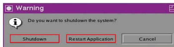
Si se habilita la opción **Use startup/shutdown password (Usar contraseña de inicio/parada)** en el menú **Configuration/General (Configuración/General)**, el sistema solicitará una contraseña antes de detenerse. Introduzca la contraseña de acceso de **Technician (Técnico)** o **Maintenance (Mantenimiento)**.
