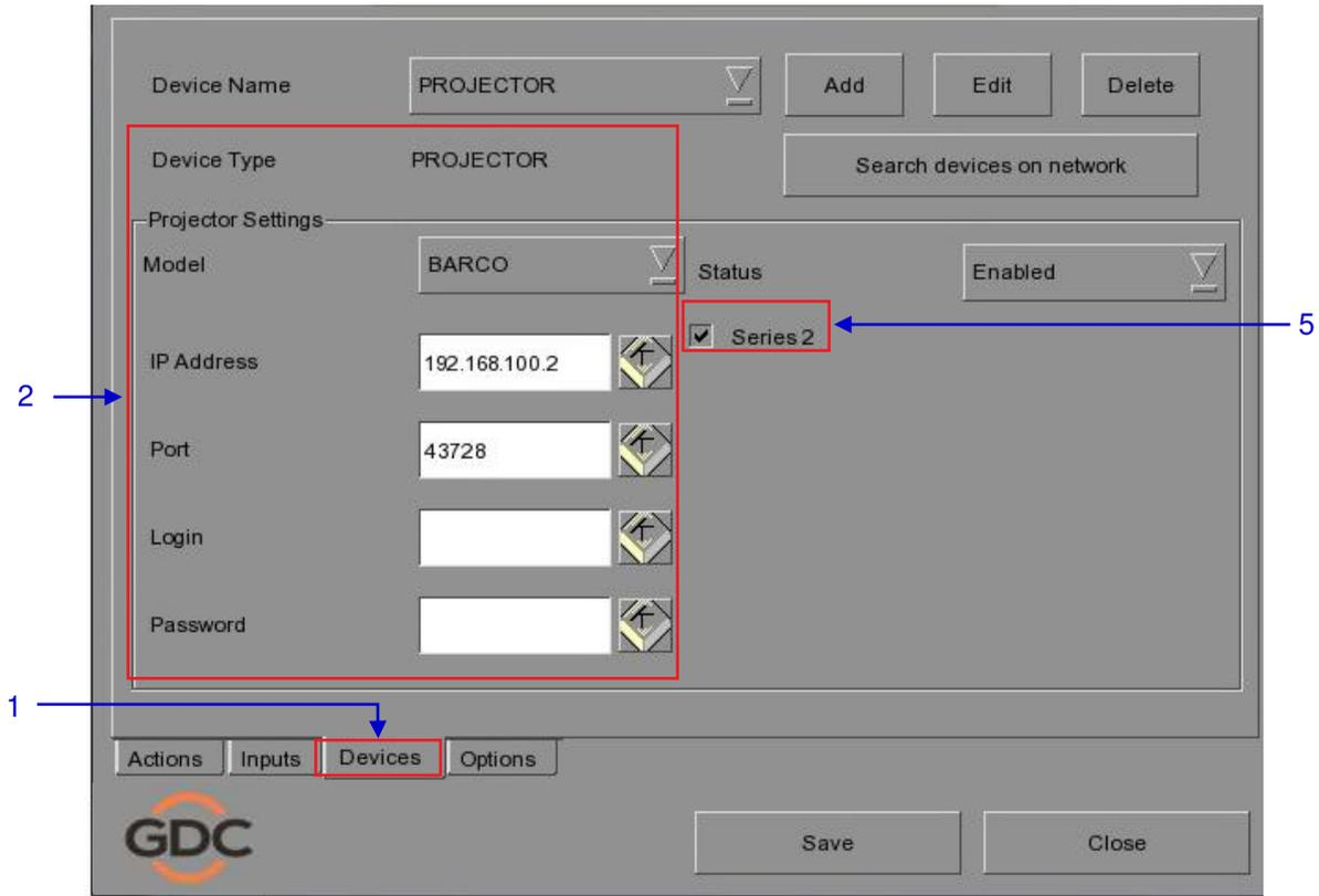
Figura 41 Configuración del tipo de dispositivo.
