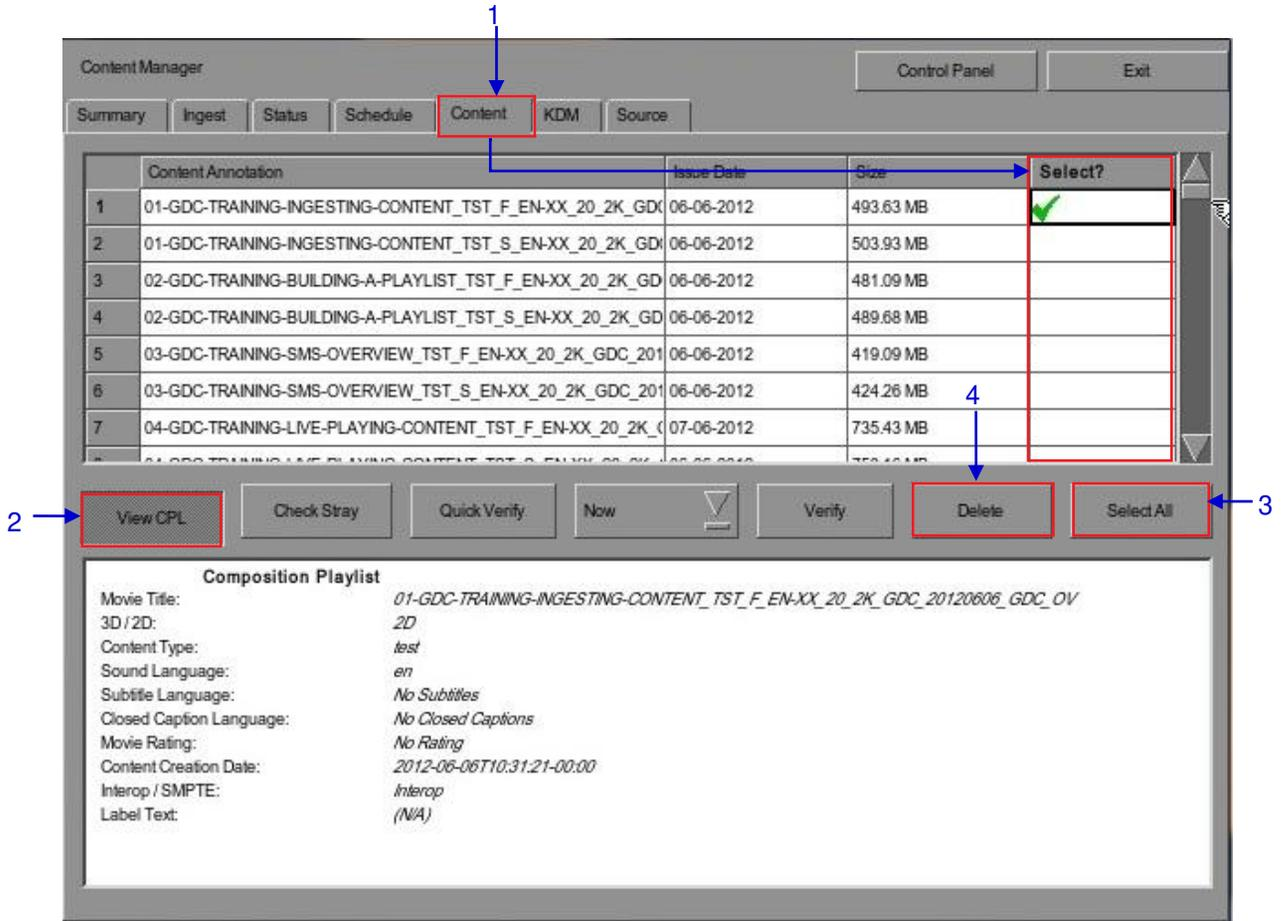
Figura 62 Eliminación de un paquete o CPL descargado.
