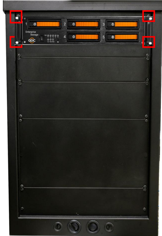
图 31 将企业级存储系统安置在基座上
