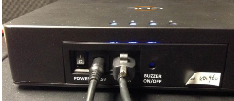
图 26 连接 eSATA 线到便携型存储设备.
