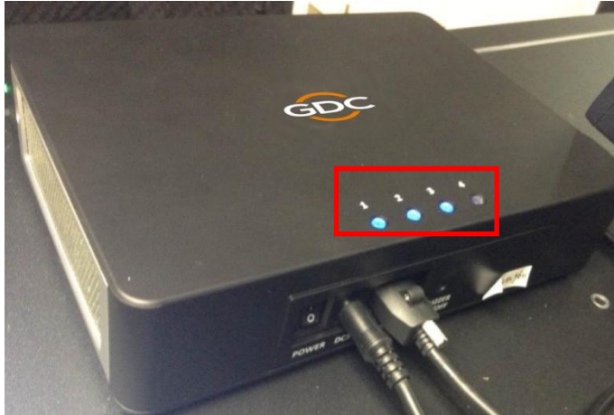
图 28 硬盘状态 LED 指示灯
