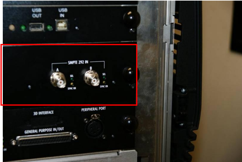
图 3 从巴可放映机中移除接口板
