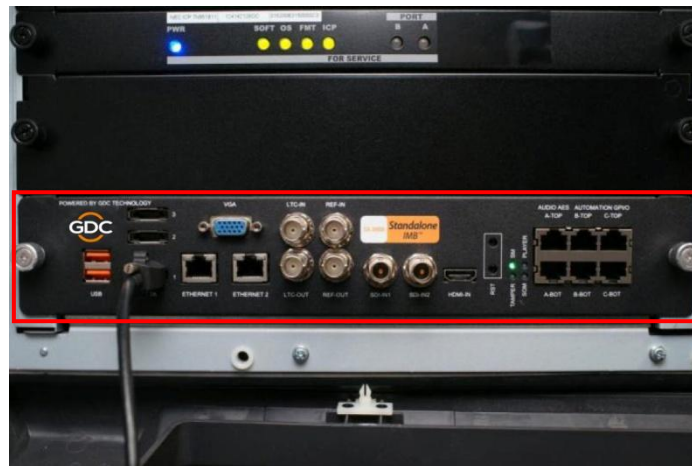
图 6 SX-3000 安装在 NEC 放映机上
