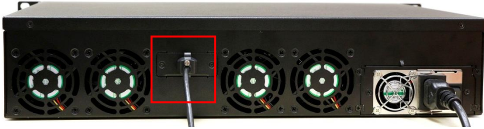
图 32 连接 eSATA 线到企业级存储系统
