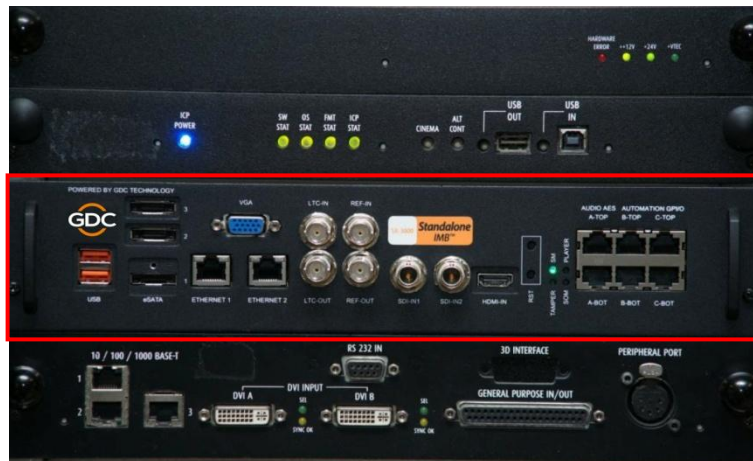
图 4 SX-3000 安装在巴可放映机上
