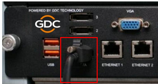
图 27 将 eSATA 线连接到 SX-3000 的 eSATA 端口 1.
