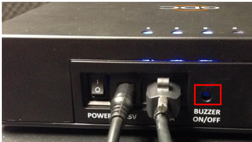
图 29 蜂鸣器切换开关.
