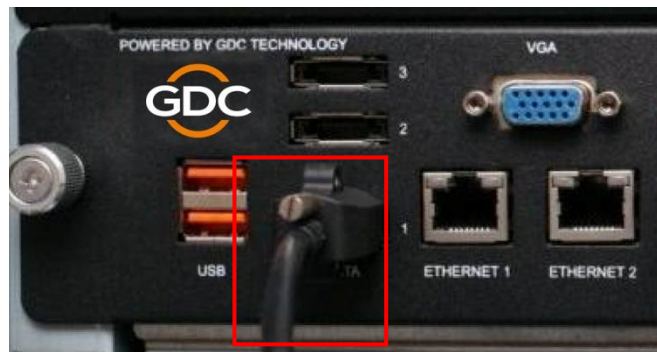
图 33 将 eSATA 线插入到 SX-3000 的 eSATA 端口 1.
