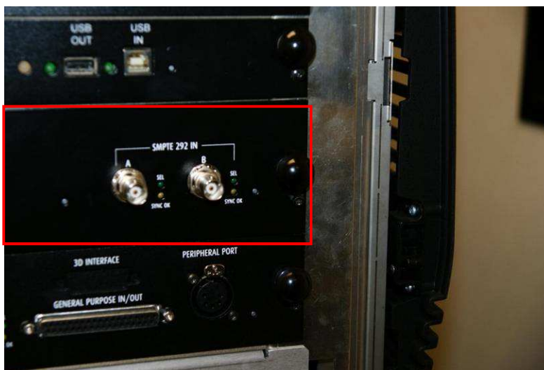
图 3 从巴可放映机中移除接口板。
