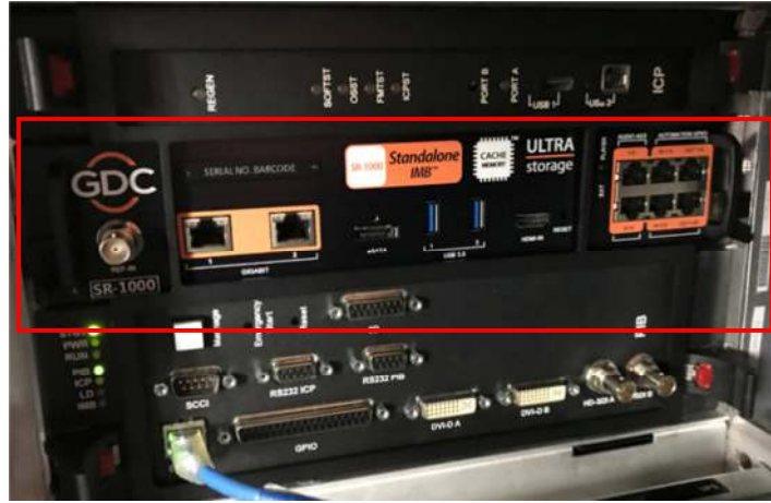
图 5 SR-1000 安装在科视放映机上。
