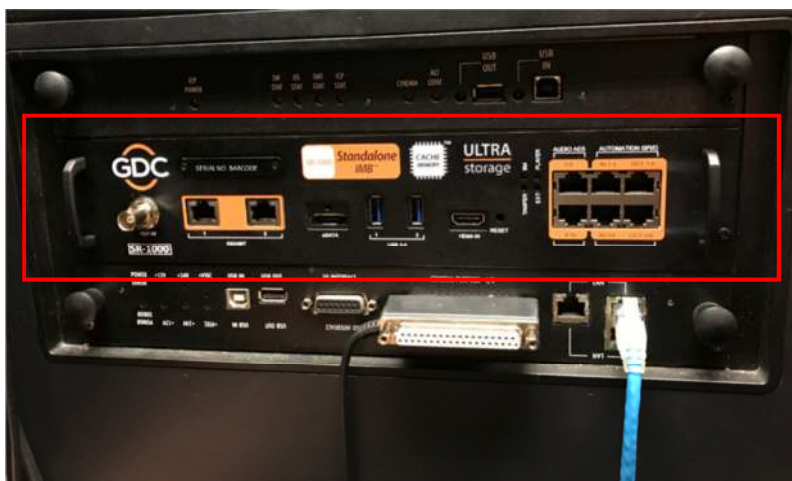
图 4 SR-1000 安装在巴可放映机上。
