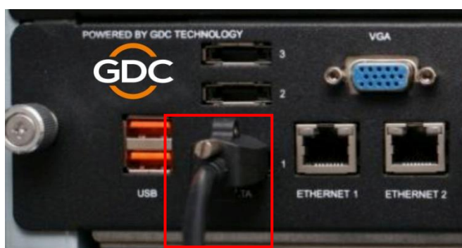
Figura 33 Inserte el cable eSATA en el puerto 1 eSATA del SX-3000.
