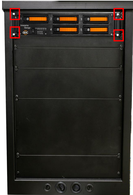
Figura 31 Coloque el Almacenamiento Empresarial en el pedestal.
