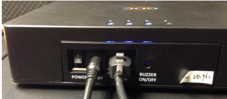
Figura 26 Conecte el cable eSATA al Almacenamiento portátil.
