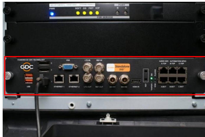
Figura 6 Colocación del SX-3000 en el proyector NEC.
