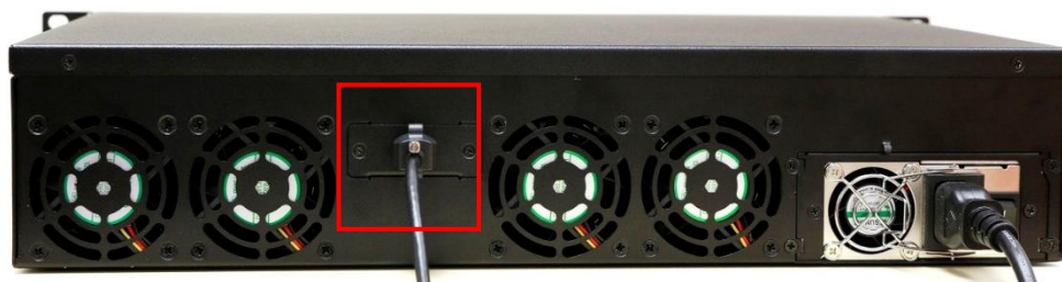
Figura 32 Conecte el cable eSATA al Almacenamiento Empresarial.
