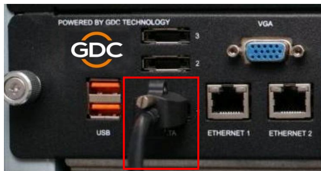
Figura 27 Inserte el cable eSATA en el puerto 1 eSATA del SX-3000.
