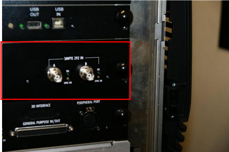
Figura 3 Extraiga la placa de interfaz del proyector Barco.
