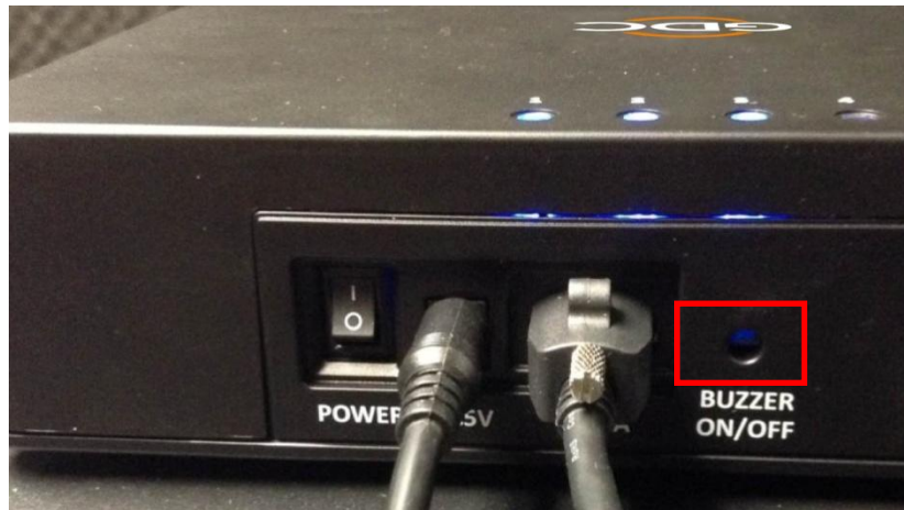
Figura 29 Interruptor basculante para Encender/Apagar el zumbador.
