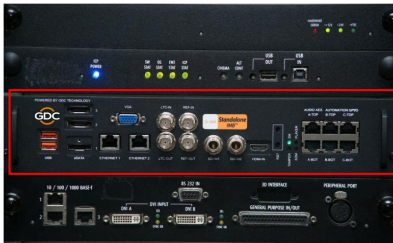
Figura 4 Colocación del SX-3000 en el proyector Barco.
